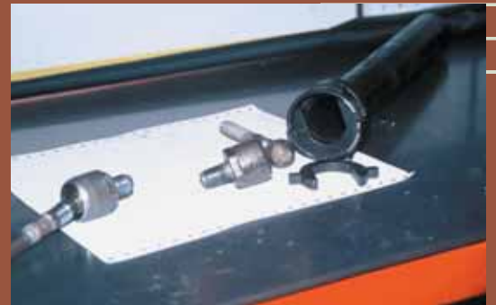
Figure 1. À gauche, une bielle désassemblée normalement. À droite, la bielle brisée ainsi que l'outil générique de désassemblage.
