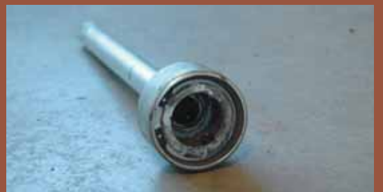
Figure 2. Placer les douilles face à face permet de vérifier rapidement si elles se sont ouvertes ou si elles sont en bon état.
